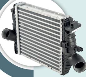
L'intercooler est un refroidisseur d'air placé près du radiateur, généralement en dessous. Son rôle est de refroidir l'air qui a été comprimé par le turbocompresseur. En effet un air plus froid (et donc plus dense) se traduit par de meilleures performances dues à un rendement du moteur optimisé et donc une consommation de carburant moindre et par conséquent moins de pollution.
